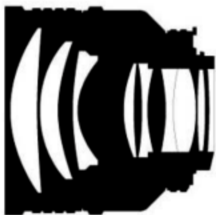
Ilustración 2. Esquema óptico de un objetivo. En este caso tiene 9 lentes.
